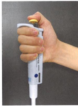
図10 1段階目まで押したところ。 このまま、液面にチップの先端 をつける。
