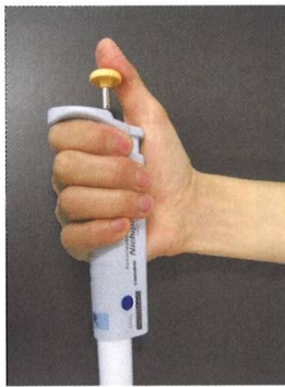
図9 マイクロピペットの持ち方 ピペットは軽く握り、親指で プッシュボタンを操作する。
