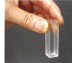
図7 セルの持ち方 写真のようにセルの曇り面を持つか、あるいは角を持つようにする。
